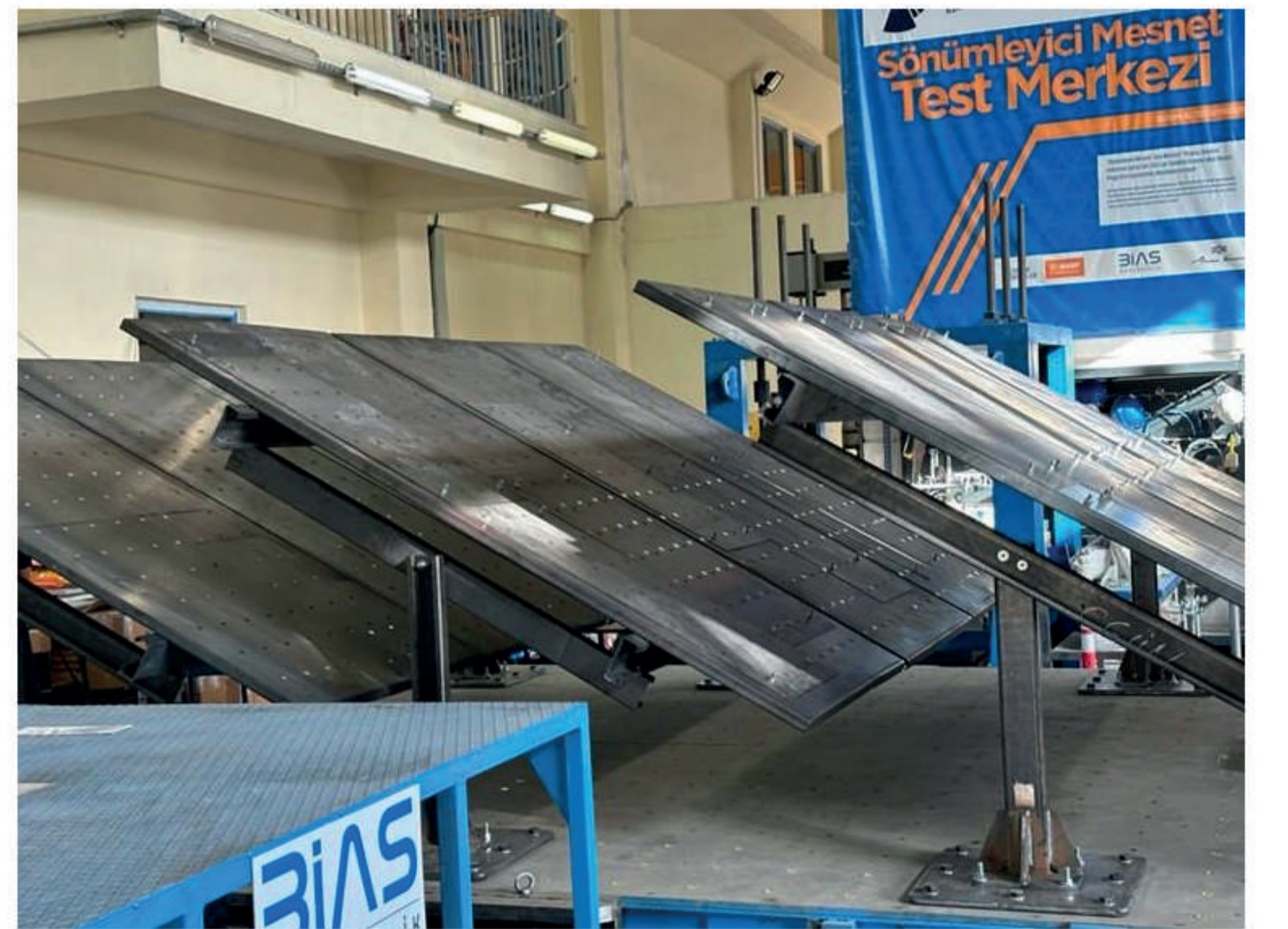
Şekil 1: Test edilen güneş enerji santrali alt taşıyıcı konstrüksiyon sistemine ait fotoğraflar
